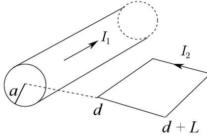
Figura 2: El eje del cilindro coincide con el eje  $z$ , el eje  $y$  se coloca de modo que el borde inferior de la espira quede sobre el eje  $y$ . El eje  $x$  apunta hacia arriba.
